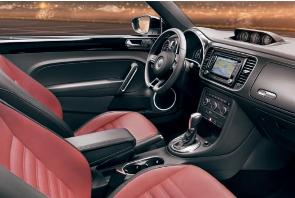
und „b“. Über dieses Rad werden die Farben der in dieser Form bei Volkswagen als Novum eingesetzten Ambientebeleuchtung geregelt: Rot, Weiß und Blau. Eine indirekte Beleuchtung selbst befindet sich dabei in den Türbrüstungen, eine direkte als Leuchtring außen an den Türlautsprechern. Angeboten wird die Ambientebeleuchtung als Paket in Kombination mit dem ebenfalls optionalen Fender-Soundsystem (*siehe Kapitel Individualisierung*).
