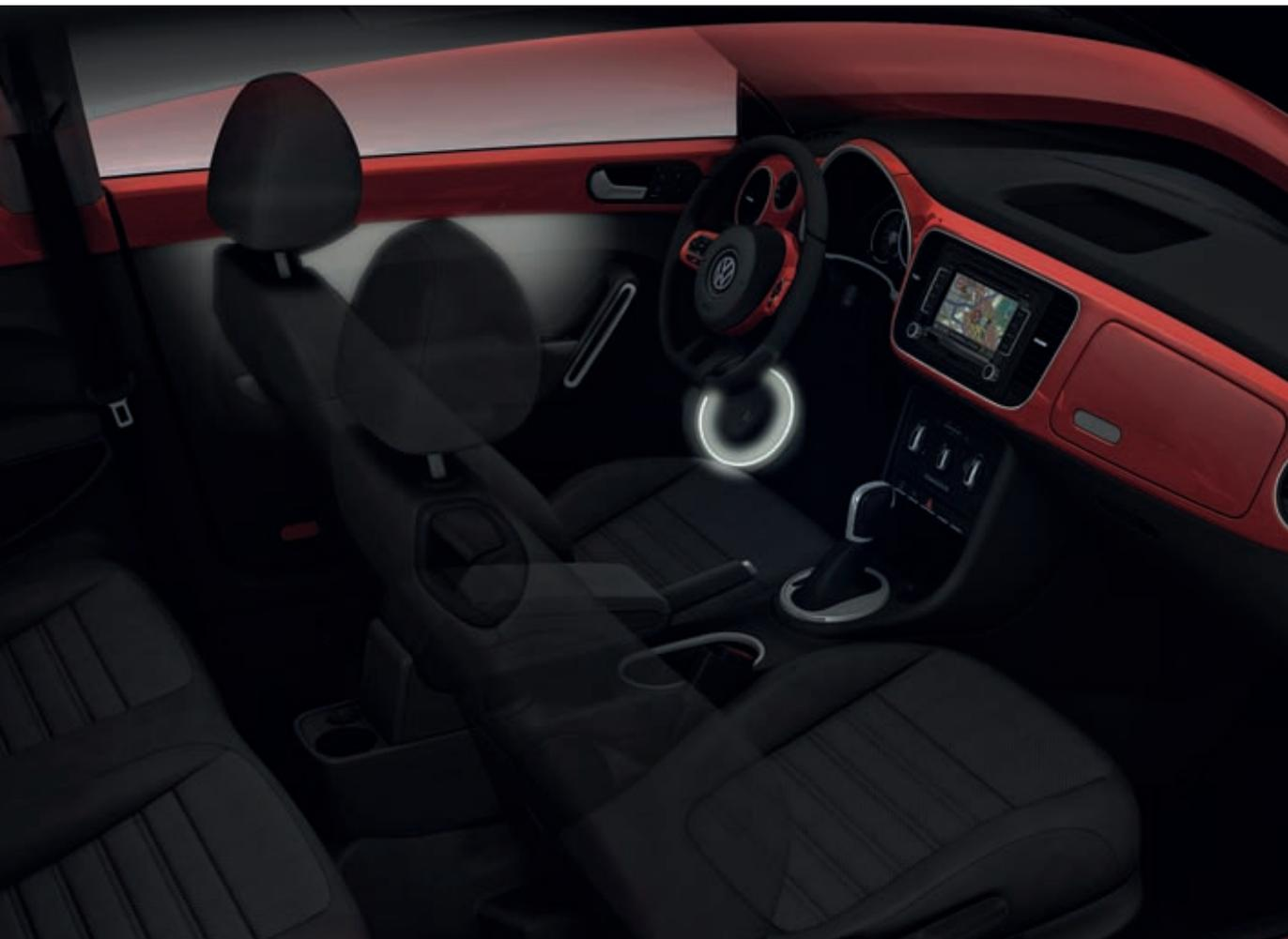
„b“. Über dieses Rad wird die in dieser Form bei Volkswagen als Novum eingesetzte Ambientebeleuchtung geregelt. „r“, „w“ und „b“ stehen für die Farben der Ambientebeleuchtung: Rot, Weiß und Blau. Eine indirekte Beleuchtung selbst befindet sich dabei in den Türbrüstungen, eine direkte als Leuchtring außen an den Türlautsprechern. Angeboten wird die Ambientebeleuchtung als Paket in Kombination mit dem ebenfalls optionalen Fender-Soundsystem.
