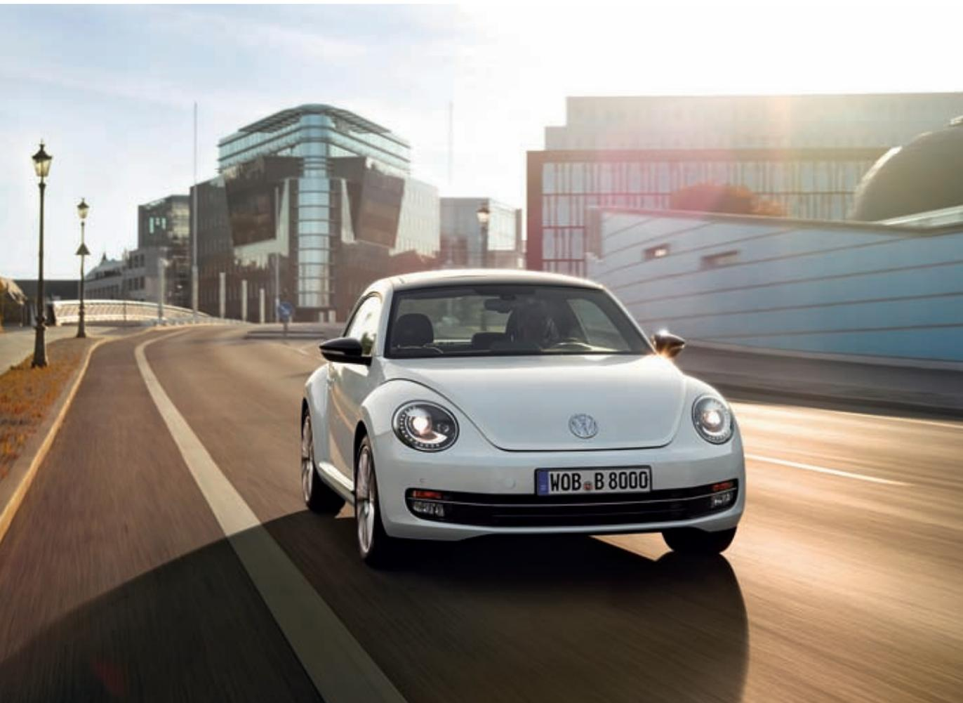
modul kommen quecksilberfreie Xenon-Gasentladungslampen mit einer Leistungsaufnahme von jeweils 25 Watt zum Einsatz. Im Fall der Bi-Xenonscheinwerfer wird das Tagfahrlicht zudem aus 15 am äußeren Rand des Scheinwerfergehäuses angeordneten LEDs gebildet.
