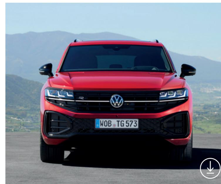
Zum Tagfahrlicht der „IQ.Light – HD-Matrix-Scheinwerfer“ gehört eine weiße LED-Querspange im Kühlergrill.
