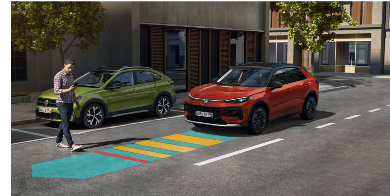
„Front Assist“ mit Fußgänger- und Radfahrererkennung
