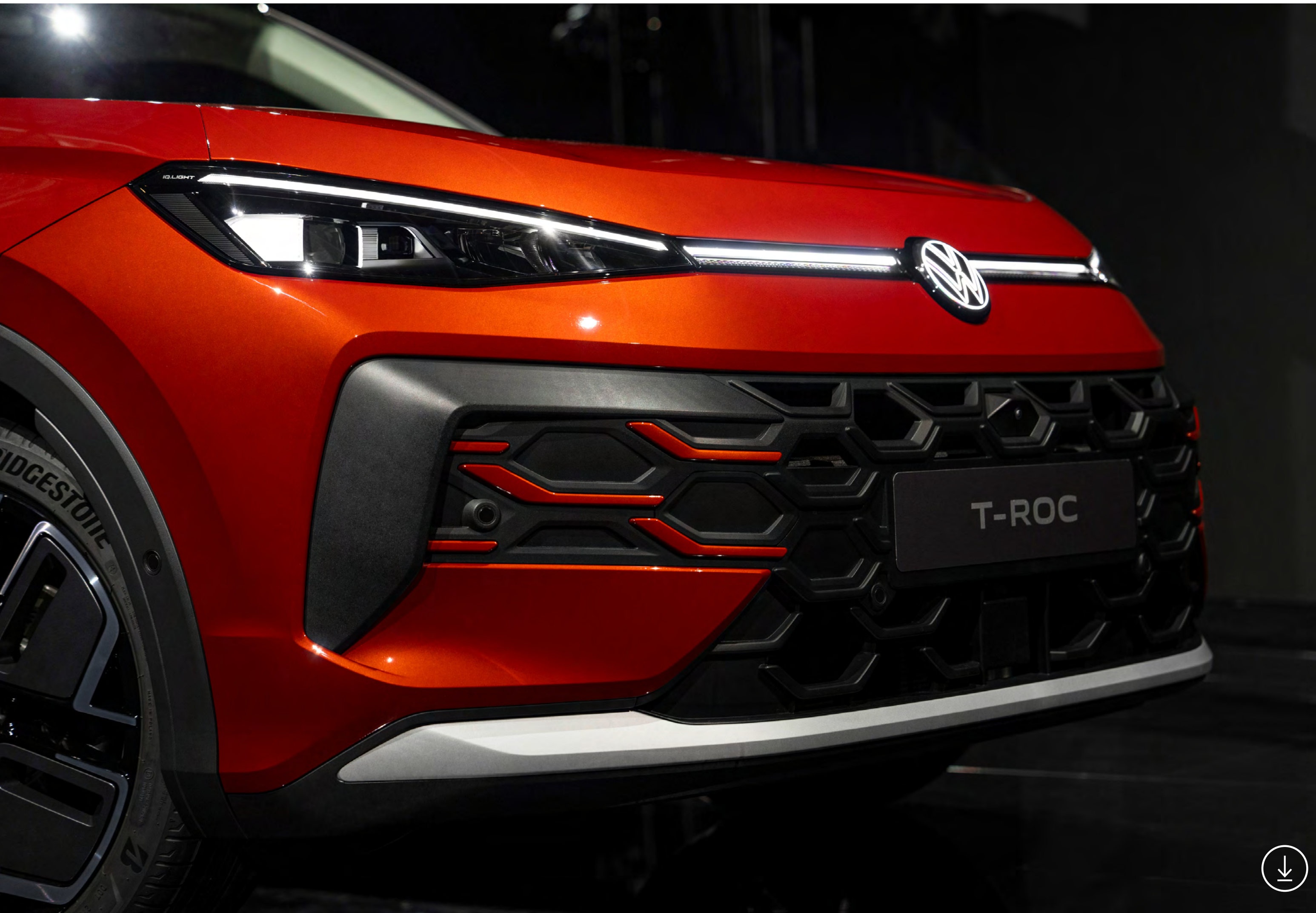
Aerodynamisch optimierte Frontpartie mit schwarzen Air Blades (links) und silbernem Spoiler
