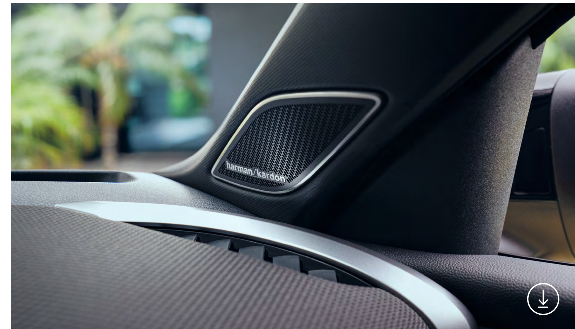
In die A-Säule integrierter Hochtöner des Harman Kardon Soundsystems
