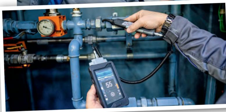
Messung: Mithilfe eines digitalen Ultraschallgeräts lässt sich ausströmende Luft aufspüren.
