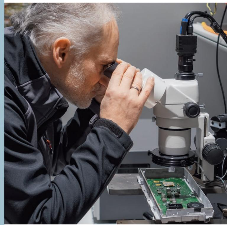
Mit dem Mikroskop: Torsten Polte bewertet in der Technischen Entwicklung die elektronischen Bauteile.
