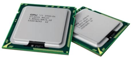
Aus dem Wafer werden die Chips herausgeschnitten, in ein Gehäuse eingebaut und final getestet.
