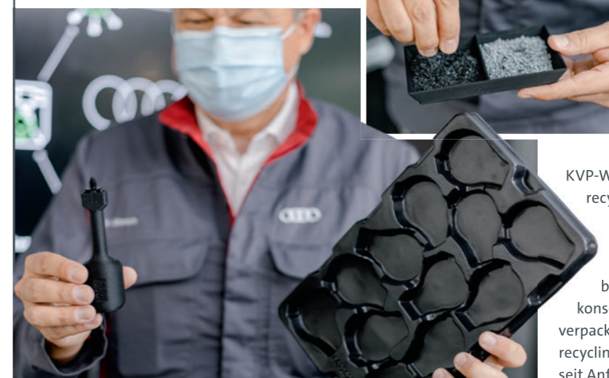
Wie ein verlängerter Finger: Mit der Drückhilfe können die Mitarbeiter an der Linie Clips leichter verbauen. Oben: das „Filament“ für den 3D-Druck.
