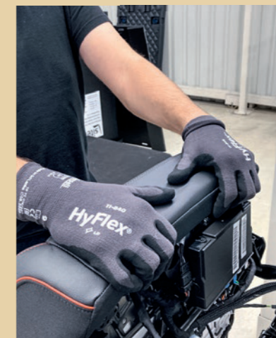
Hier wird gemessen: Ein Beschäftigter demonstriert einen Bewegungsablauf im Fertigungsbereich. Ein Handschuh mit ausgerichteten Sensoren sammelt wichtige Erkenntnisse.
