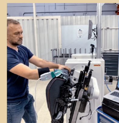
Aufschlussreich: Viktor Fleitling aus dem Bereich Festigkeit und Funktion am Sitech-Standort Wolfsburg zeigt die Messwerte des Sensorhandschuhs beim Verschließen des Sitzbezugs.
