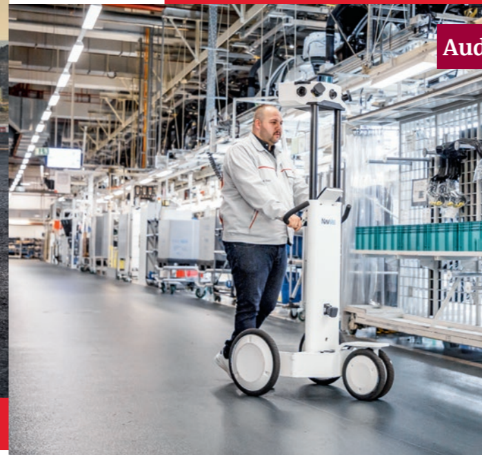
Das Werk gescannt: Am Standort Neckarsulm hat Audi Produktionshallen und komplette Gebäude dreidimensional erfasst.
