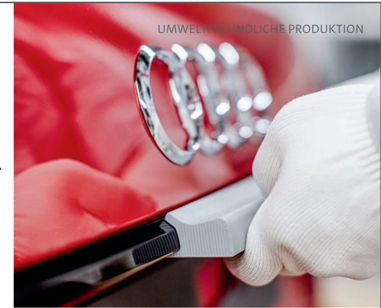
Montagehilfe im Einsatz: So lassen sich die vier Ringe passgenau am Heck anbringen.
