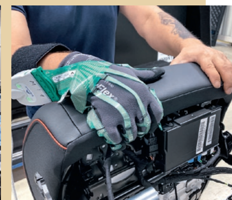
Aufschlussreich: Viktor Fleitling aus dem Bereich Festigkeit und Funktion am Sitech-Standort Wolfsburg zeigt die Messwerte des Sensorhandschuhs beim Verschließen des Sitzbezugs.
