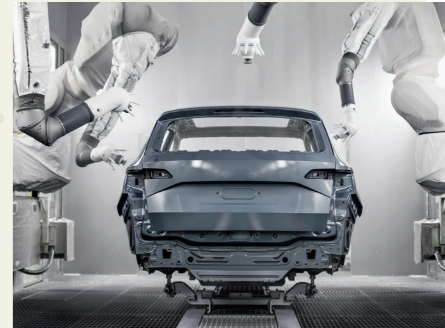
Energieverbrauch runter: Lackiererei in Mlada Boleslav spart Lösungsmittel sowie Klarlack und reduziert die Farbreste.
