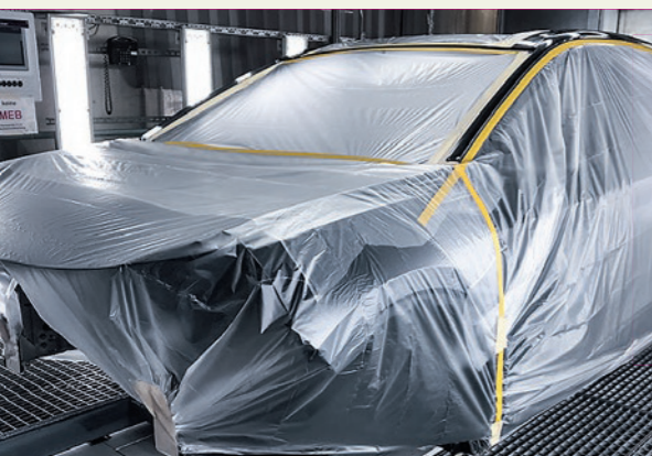
Eine Karosserie mit Folie, Kreppband und Tape: Das Maskiermaterial soll nicht mehr verbrannt, sondern wiederverwertet werden.
