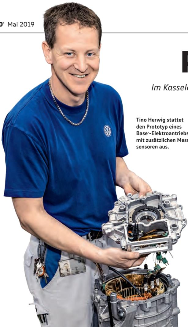
Tino Herwig statet den Prototyp eines Base-Elektroantriebs mit zusätzlichen Messsensoren aus.
