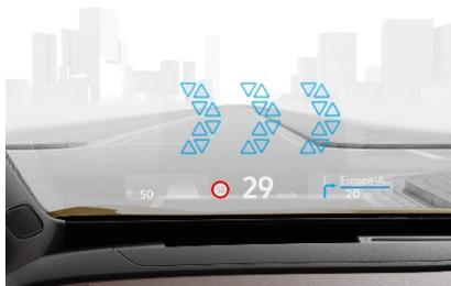
**Das neue Augmented-Reality-Head-up-Display setzt zunächst in den vollelektrischen Modellen ID.3 und ID.4 ein.**
