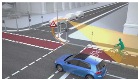
Sensoren an der Ampel erfassen den Radfahrer und warnen den Autofahrer
