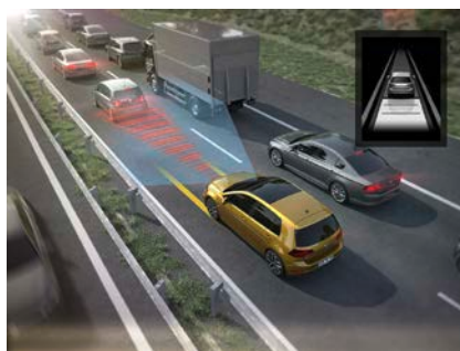
Der Stauassistent unterstützt den Fahrer bei stockendem Verkehr durch automatisches Betätigen von Gas und Bremse und das Halten der Fahrspur.
