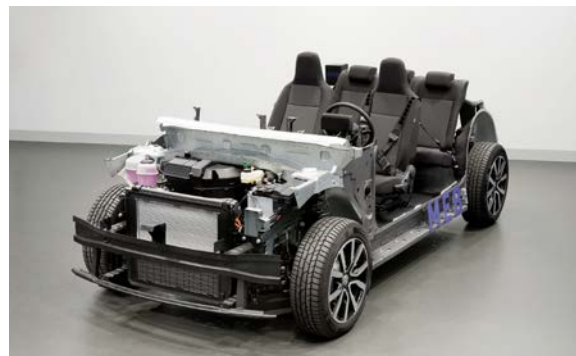
Rolling Chassis mit dem Modulare E- Antriebsbaukasten (MEB) - Erste reine Elektroplattform für Volumenmodelle.
