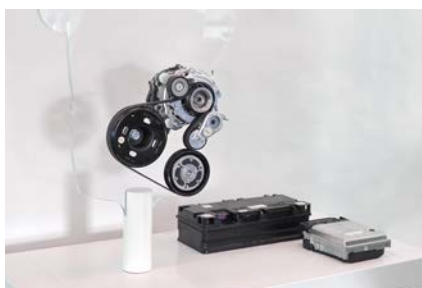
48V-Riemen-Startergenerator, 48V-Batterie und DC/DC-Wandler
