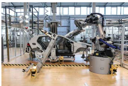
Weltneuheit: Der Einbau des Dachhimmels beim e-Golf erfolgt ab sofort automatisiert.
