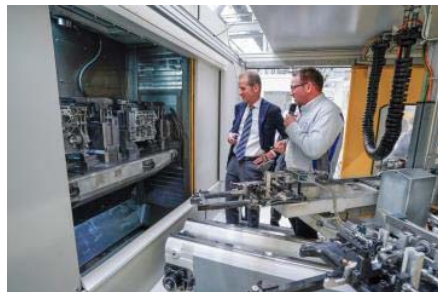
Planer Sebastian Rost (rechts) erläutert Dr. Herbert Diess ein standardisiertes Aufnahme-konzept für Zylinderkurbelgehäuse, das Umbauzeiten und -kosten deutlich verringert.
