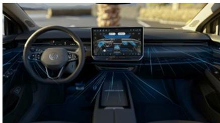
Die intelligenten Luftausströmer werden elektronisch gesteuert und verteilen die Luft durch dynamisches Wedeln schnell im Innenraum.
