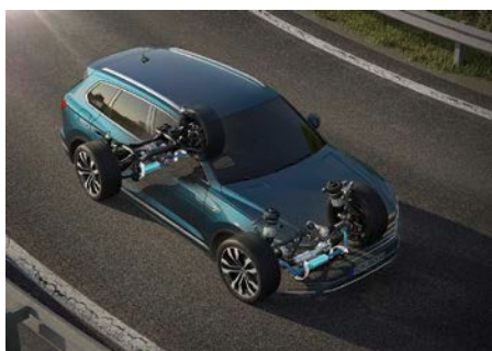
Touareg mit elektromechanischen Stabilisatoren
