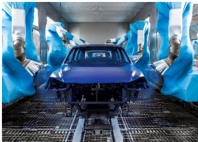
In der Lackiererei spart eine lastabhängige Volumenstromregelung Strom und häufig Erdgas und senkt den CO 2 -Ausstoß
