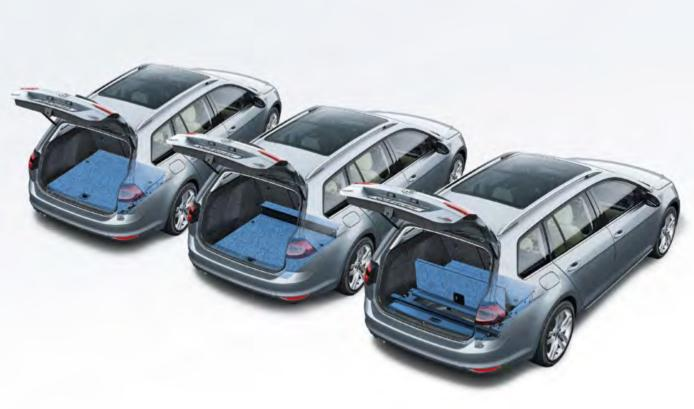
Die Laderaumlänge bis zur Rückbank beträgt 1.055 mm; bis zu den Rücklehnen der Vordersitze ergibt sich mit 1.831 mm ein Gesamtplus von 131 mm. Wird die Beifahrersitzlehne umgeklappt (Comfortline), können bis zu 2.671 mm lange Gegenstände transportiert werden. Wie skizziert, korrespondiert die optimale Raumausnutzung des Laderaums mit den Gardemaßen der Heckklappenöffnung (675 mm Höhe; 1.031 mm Breite).
