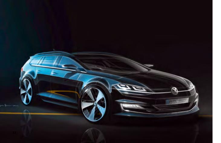
definiert maximale Höhe des Kühlergrills. Nach unten wird der Kühlergrill durch einen Chromsteg begrenzt, der im Fall der Xenonscheinwerfer seine Fortsetzung in den Scheinwerfergehäusen findet.
