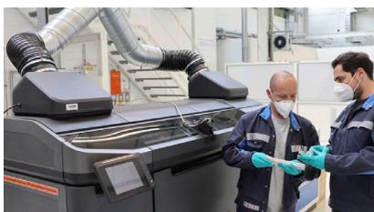
Zwei Mitarbeiter von Volkswagen prüfen die Qualität von im Binder-Jetting-Verfahren hergestellten Strukturteilen für die Autoproduktion vor dem Prototyp des Spezialdruckers im Wolfsburger 3D-Druck-Zentrum.
